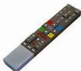
**Infra-Rouge** : communication via un faisceau lumineux infra-rouge (invisible à l'œil humain), courtes distances et nécessité de pointer vers le récepteur et en l'absence d'obstacle.
