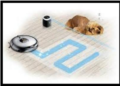
Ou encore ,un robot-aspirateur utilise de l'**énergie électrique** qui est transformée en **énergie mécanique** pour se déplacer et nettoyer. Ce système automatisé a besoin d'**informations** pour détecter des obstacles, éviter de tomber, retrouver sa base pour se charger, savoir quand il n'y a plus de poussière à aspirer... le tout se fait automatiquement
